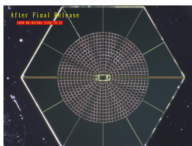
Fig. 4a: Spider Web detector at 857GHz (JPL/Caltech)
