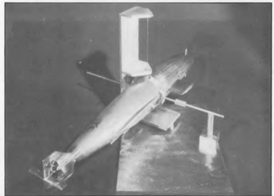
(d) Measuring vertical C.G. location
